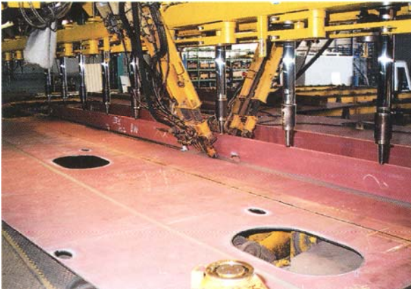
Bild: Maschine zum Aufsetzen und Verschweißen von Profilen in einer Paneelstraße 2
