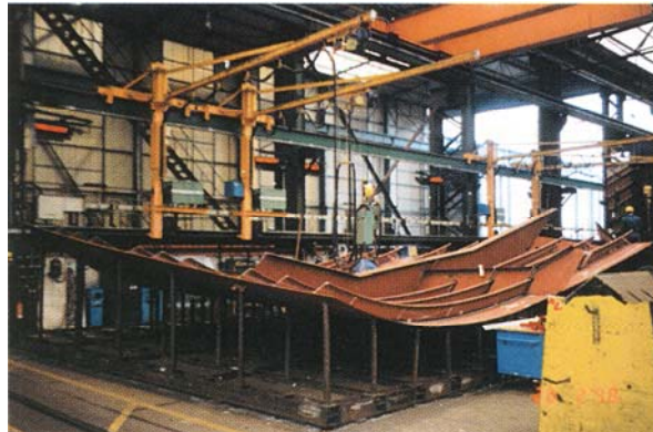
Bild: Bau einer verformten Flachsektion auf dem Stempelfeld
