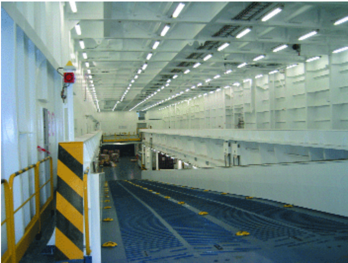
Bild: Ro-Pax-Fähre »Norröna« - Oberes Wagendeck (Deck 4) mit abge- senkter Rampe auf Deck 3 14
