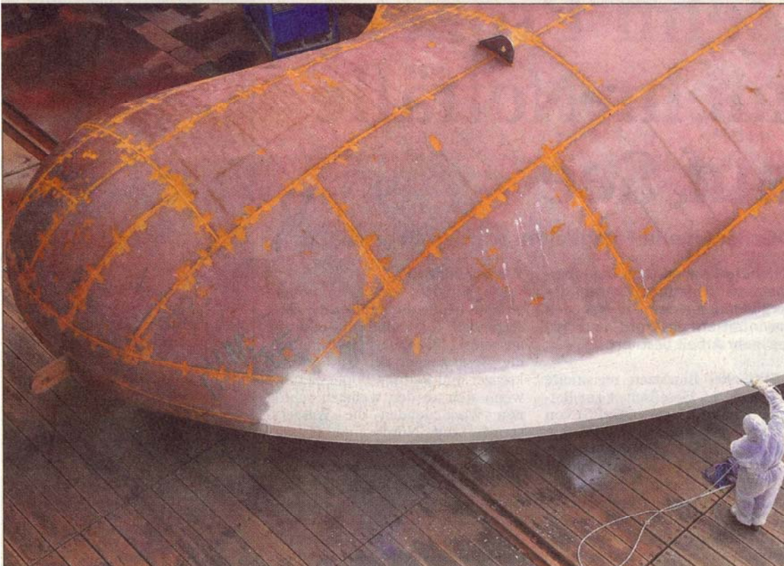
Bild: Ein Mitarbeiter der Hegemann-Werft im ostvorpommerschen Wolgast grundiert den Wulstbug eines Schiffsneubaus 9
