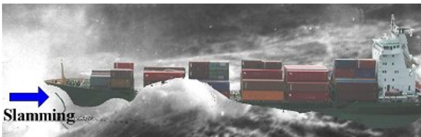
Bild 1.2: Beim Slamming erfährt ein Schiff hydrodynamische Stöße 2
